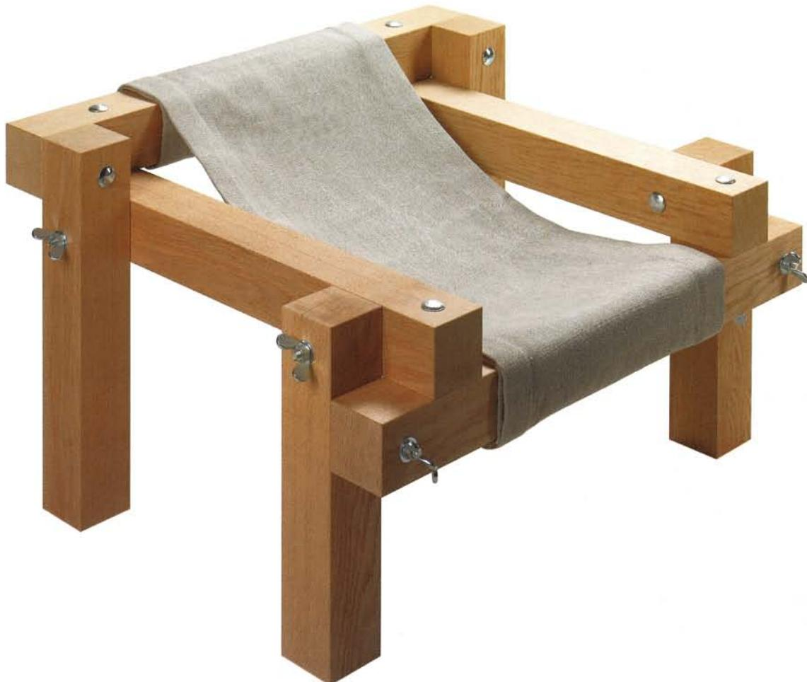
HE 9X9 wird aus über 5 m Tannen- oder Eichenbalken mit einem Profil von 9x9 cm hergestellt und an vier identischen Knotenpunkten mit verzinkten Schloss-Schrauben und Flügelmuttern starr verbunden. In diese archaische Konstruktion wird nach dem Prinzip des Liegestuhls ein rohes Leinengewebe eingehängt.
